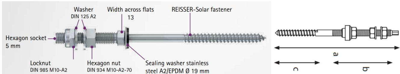
Les vis à double filetage sont disponibles en différentes longueurs et différents diamètres. Elles sont adaptées pour les structures posées sur une ossature porteuse en bois.
