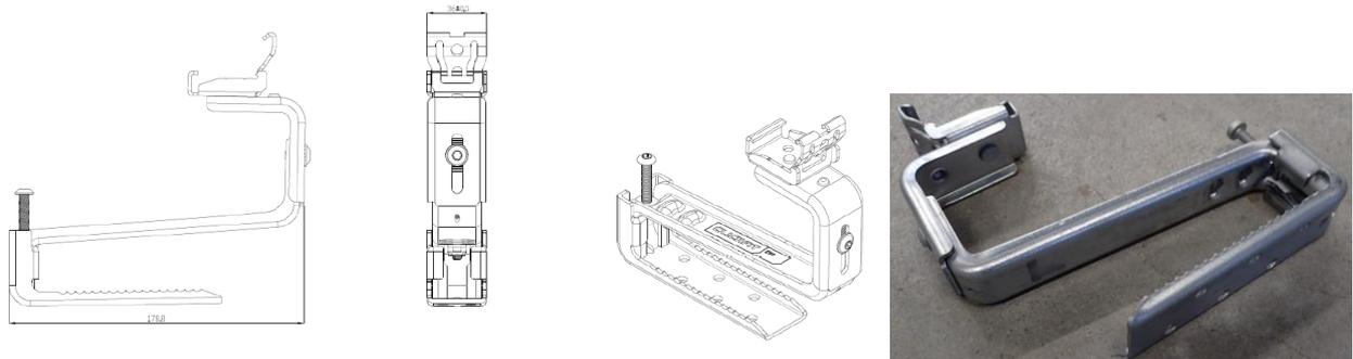
Contrairement aux crochets « Truss Hook », les crochets « Universal Hook » sont insérés sur la sous-structure bois sans aucune vis dans le bois : la liaison s'effectue par frottement (ou par pincement).
