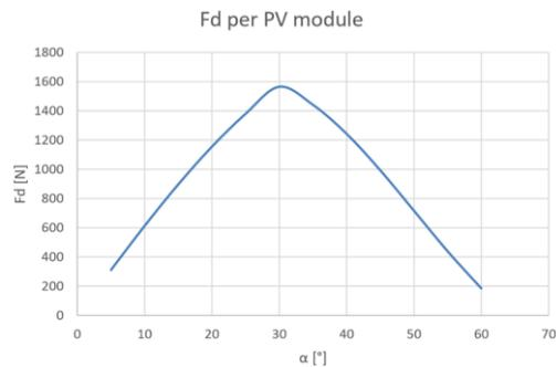
La pente vers le bas du graphique aux inclinaisons de toit supérieures à 30 ° est due à la valeur changeante de  $\mu_1$ , qui est définie comme  $0,8 (60-\alpha) / 30$  pour les inclinaisons de toit  $30^\circ < \alpha < 60^\circ$ . Avec une accumulation de neige de 2 m au niveau des panneaux supérieurs, la force parallèle est calculée comme suit :
