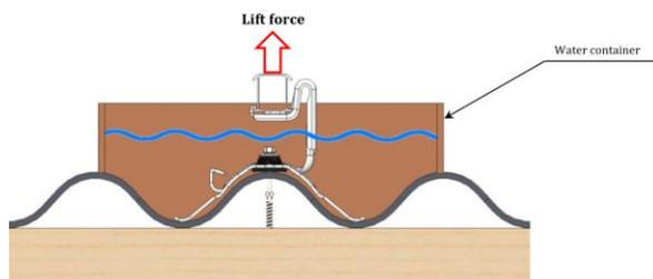
Le réservoir est rempli d'eau conformément à la section 7.3.3.3 de la norme EN494, (60 mm au-dessus de la partie supérieure des ondulations).
