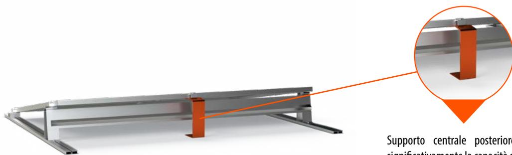
Supporto centrale posteriore aggiuntivo, progettato per aumentare significativamente la capacità di carico della neve di ogni modulo. Progettato per resistere a carichi di neve e vento fino a 2.400 Pa.
